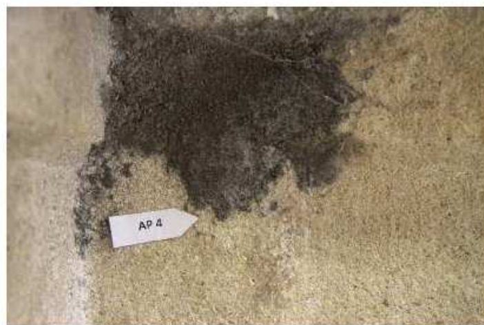
Obr. 41 Odběr vzorku 7208 (AP4 krusta) ze spodního dílu A, detail.
