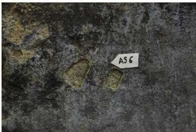
Obr. 36 Odběr vzorků, stanovení obsahu vodorozpuštěných solí, základna podstavce (A).
