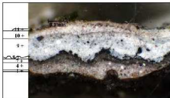
Obr. 10 Optická mikroskopie, bílé světlo, svrchní část souvrství povrchových úprav, jiná část vzorku.
