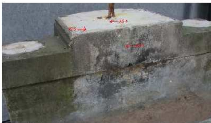
Obr. 35 Odběr vzorků AS3-AS5, stanovení obsahu vodorozpuštěných solí, základna podstavce (A).
