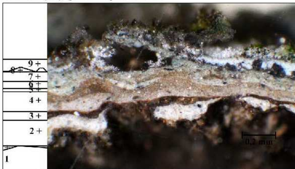
Obr. 6 Optická mikroskopie, bílé světlo, spodní část souvrství povrchových úprav.
