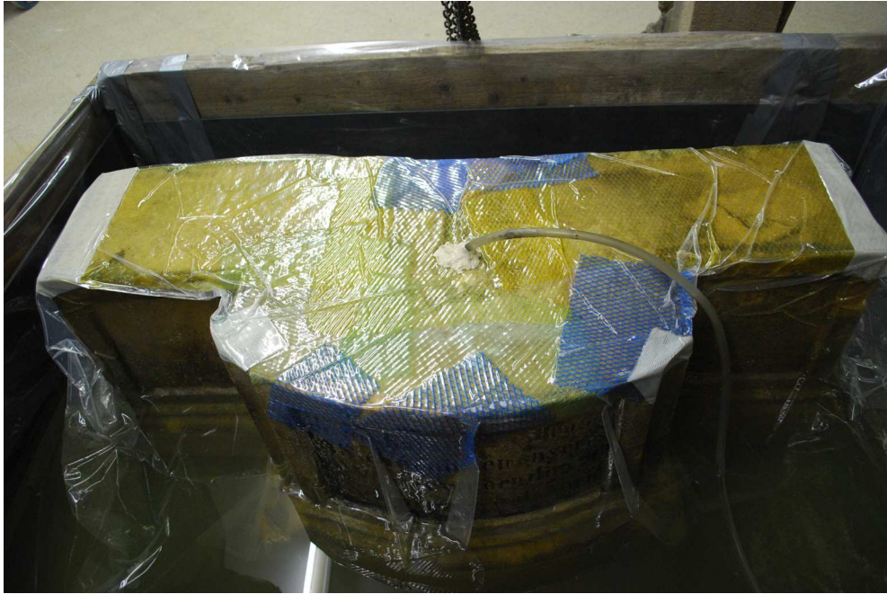
Obr. 85 Odsolování podstavce za sníženého tlaku – průběh práce
