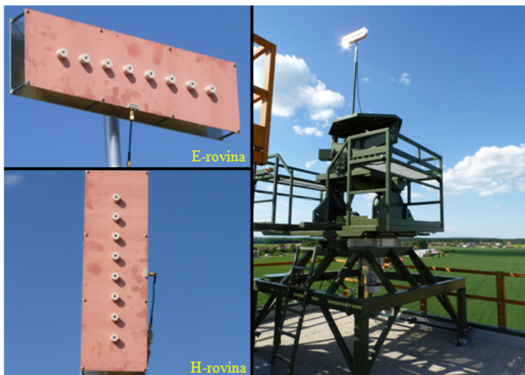
Obrázek 85 - Detail připevnění 8×DRA a otočná aparatura pro měření vyzař. char.
