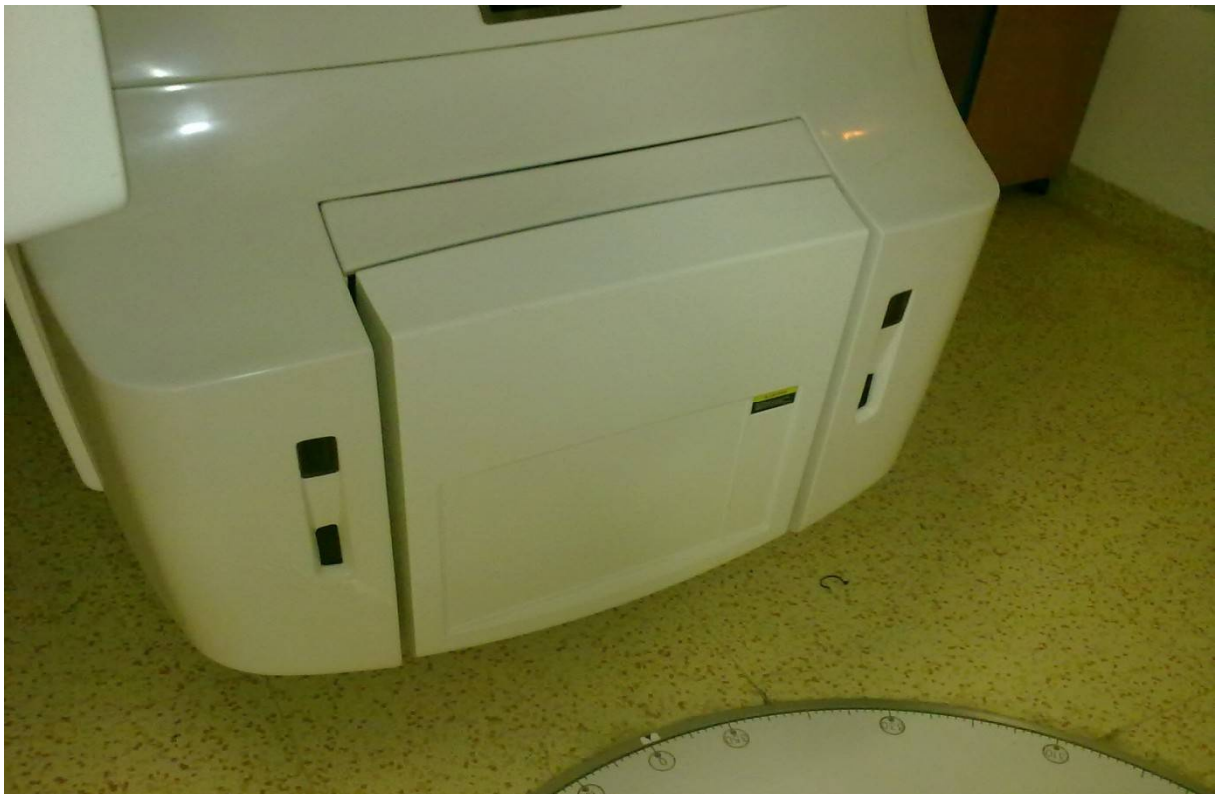
Obrázek 4 Výsuvný portál umístěný na urychlovači Clinac 2100 firmy Varian, slouží k verifikaci TPS i ověřování QA přístroje
