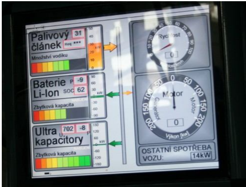
Obrázek 38: Tok energie po startu palivového článku: Palivový článek je nastartován, dodává energii, akumulátor je částečně nabit a doplňuje se, ultrakapacitory jsou téměř nabity. (50)
