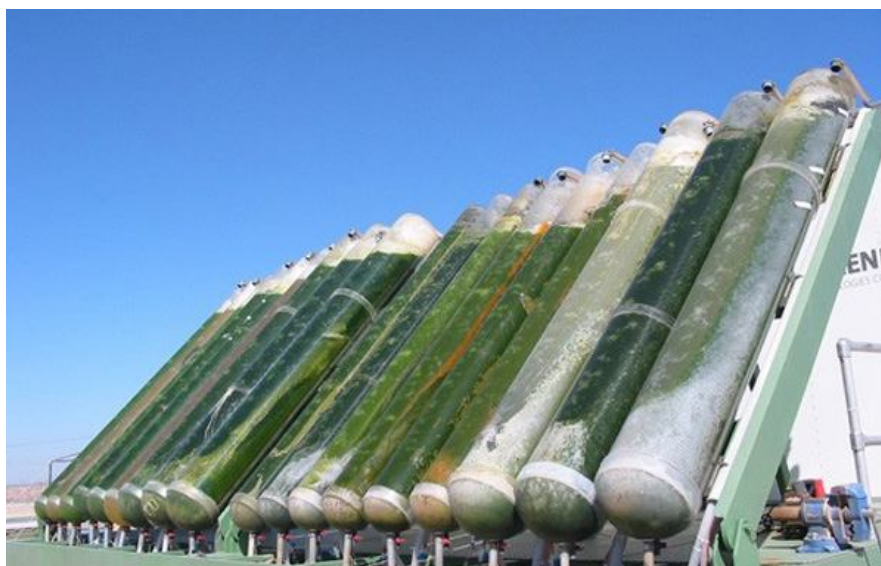
Obrázek 16: Bioreaktory, v nichž rostou řasy produkující olej. (36)
