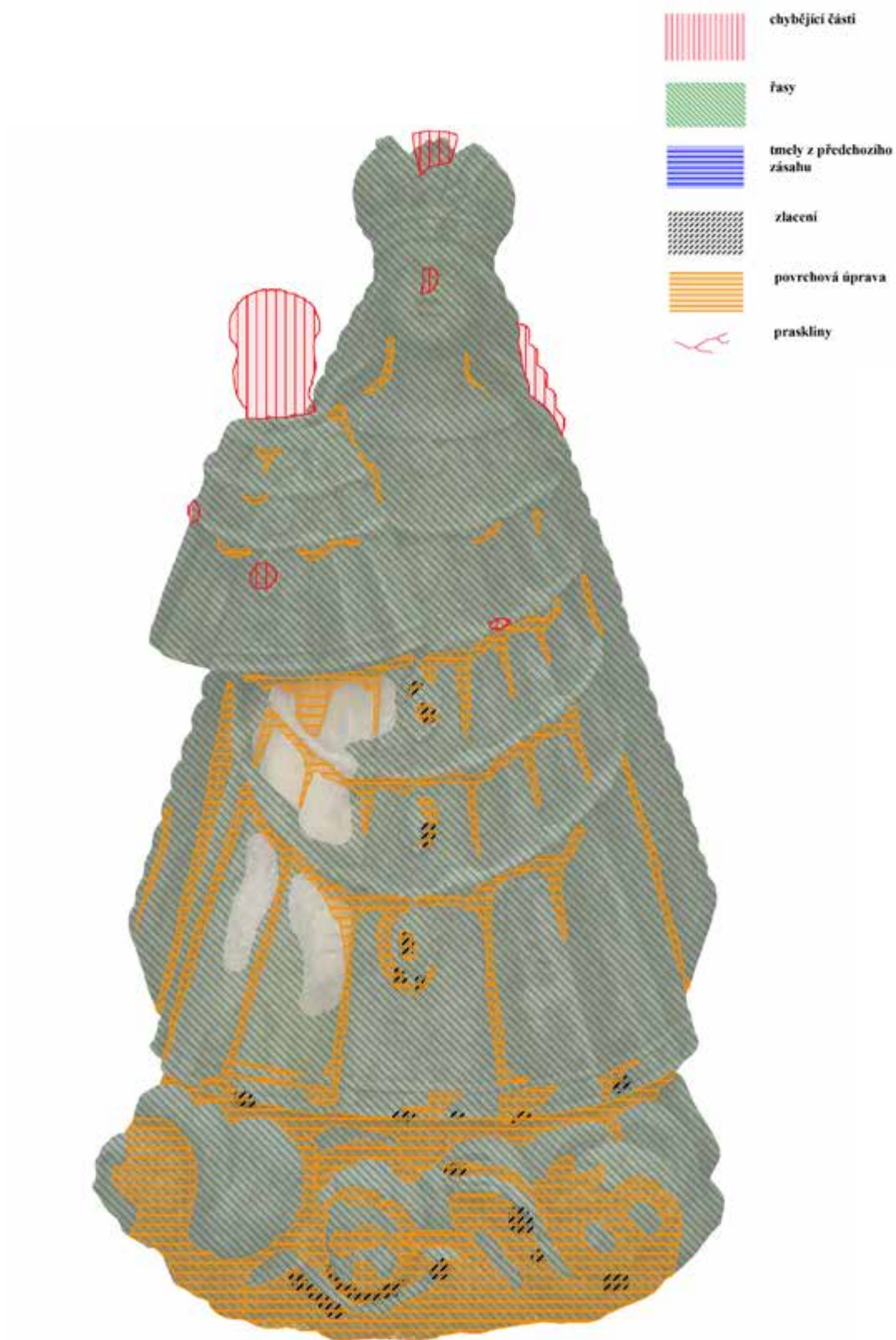
Obrázek 94 - Zákres poškození, pohled zepředu
