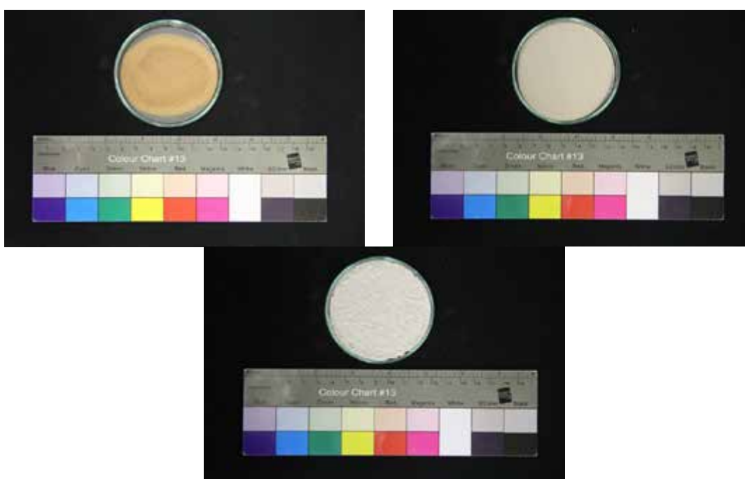
Obr. 5: Plniva použitá v jádrové a štukové omítce (vzorek 1/7279) (vlevo nahoře), povrchové štukové vrstvě (3/7281) (vpravo nahoře) a spojovací hmotě na armatuře (4/7282) (dole). Frakce D=0,125 a 0,063\text{ mm} .
