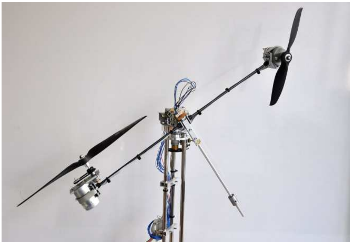
Obrázek 1.1 – Dvourotorový laboratorní model upoutané helikoptéry (HAVLÍČEK, 2010)
