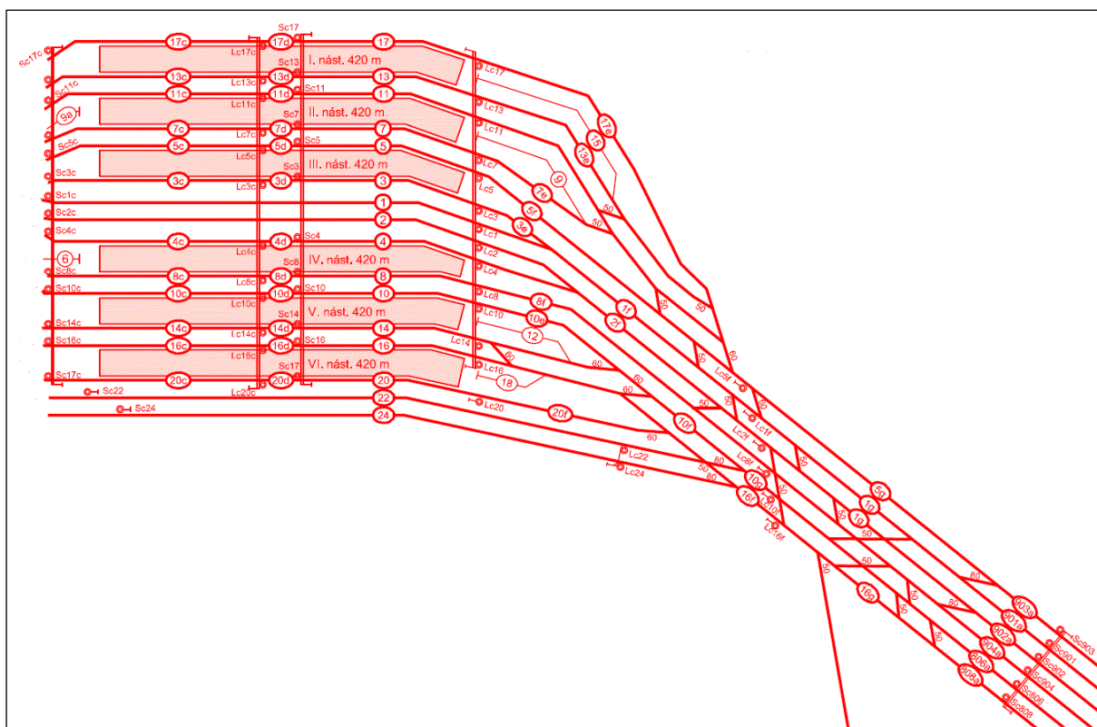
Obrázek 10: Schéma obvodu osobního nádraží a severního zhlaví
