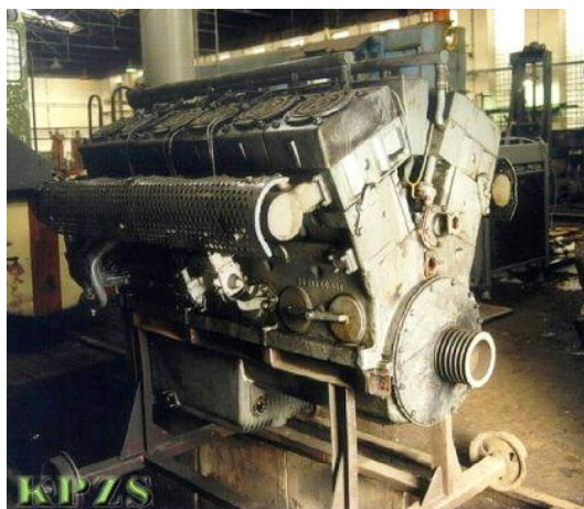
Obr. 9 Uspořádání válců v motoru 12 V 170 DR. [19]
