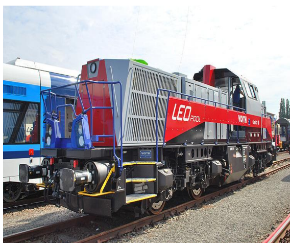
Obr. 39 Fotografie zleva doprava: Lokomotiva GRAVITA 10BB, motor V2868T3/L3. [58]
