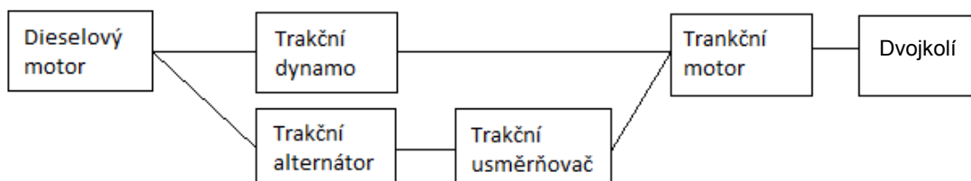
Obr. 2 Schéma elektrického přenosu stejnosměrného a střídavě stejnosměrného. [vlastní], [4]
