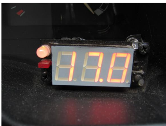
Obrázek 16: Analyzátor umístěný na palubní desce zobrazující teplotu
