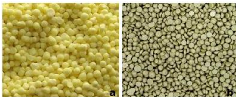
Obrázek 5: Granulovaná sírná hnojiva: (a) mikronizovaná granulovaná síra, (b) S-bentonit [13].
