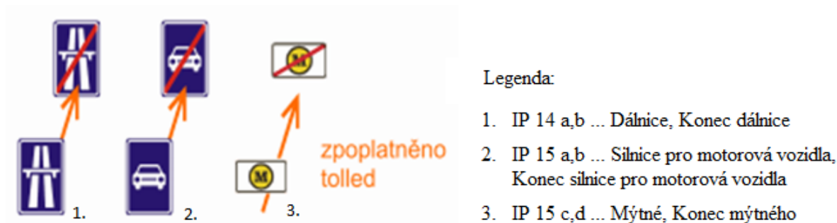
Obr. 2 – Dopravní značení vymežující placené úseky
