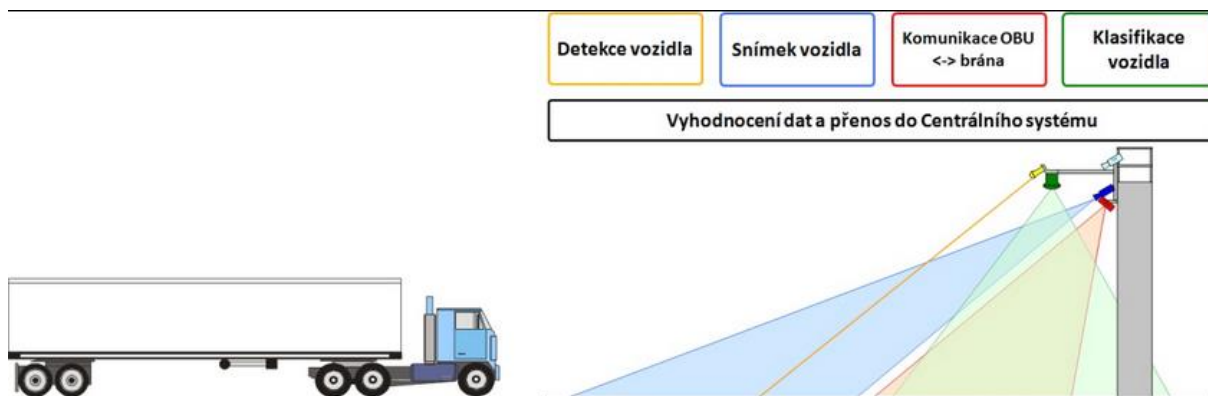
Obr. 6 – Schéma funkce kontrolní mýtné brány
