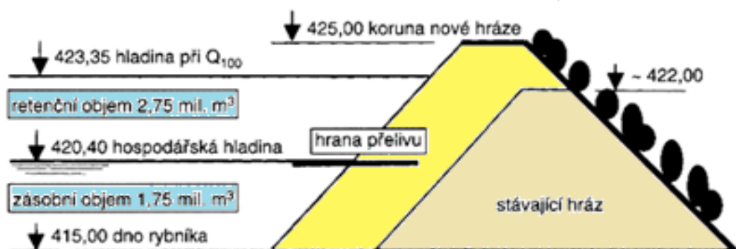
Obrázek 12: Schéma rekonstrukce nádrže Hvězda
