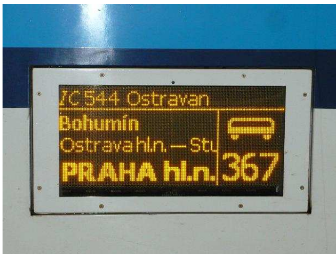
Obr. B37 Elektronický informační panel s označením čísla vozu, kategorie vlaku, čísla vlaku, obchodního názvu vlaku a relace; vůz Bpee 237
