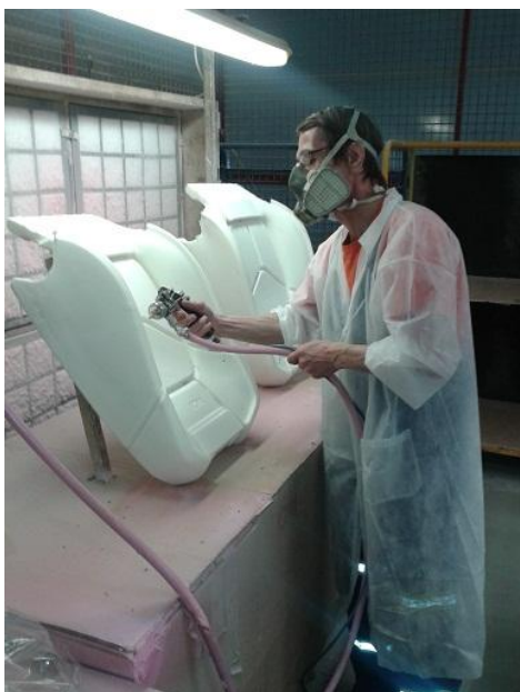
Obrázek 25: Nástřik lepidla na části pěnových dílů
