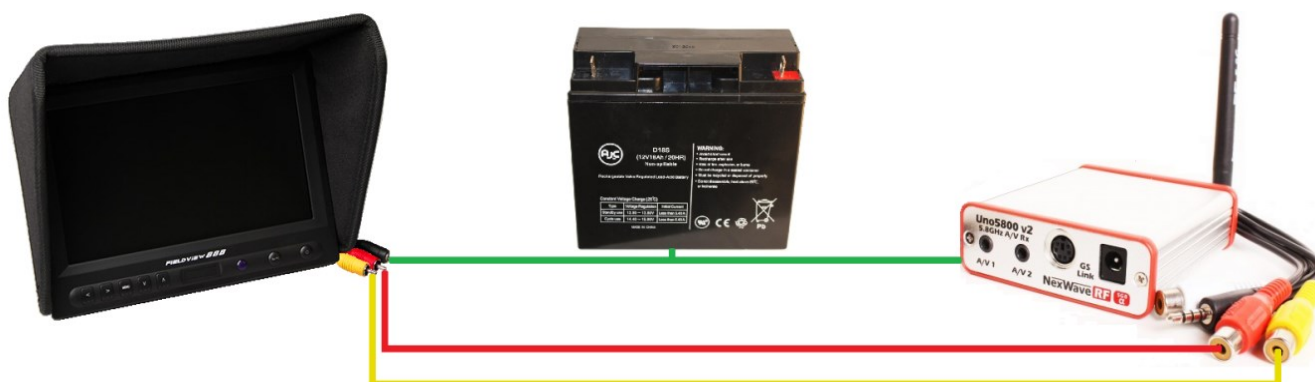
Obrázek 11 – Zapojení pozemní stanice FPV systému – možnost 1
