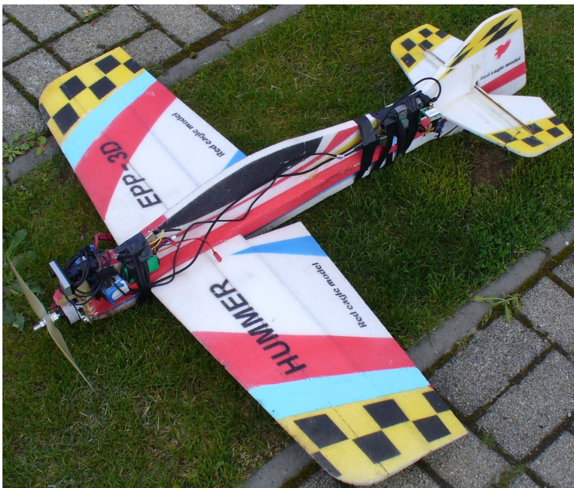
Obrázek 23 – Vzdálená stanice připevněná k RC modelu
