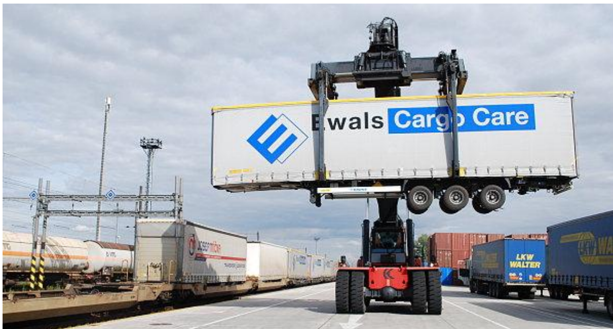
Obrázek 2: Překládka silničního návěsu na speciální železniční vůz
