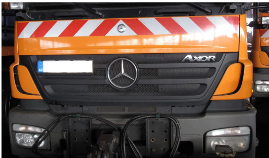
Obrázek 4 - Připojovací DIN deska na vozidle Mercedes-Benz Axor
