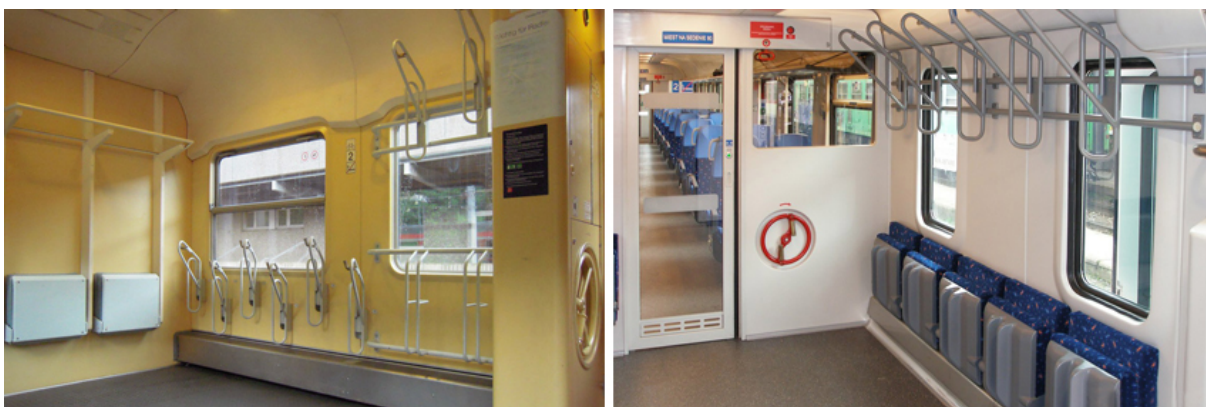
Obr. 35 Prostor pro přepravu jízdních kol se sklápěcími sedačkami ve vozech DB řady Bimdz a ŽSSK řady Bdteer
