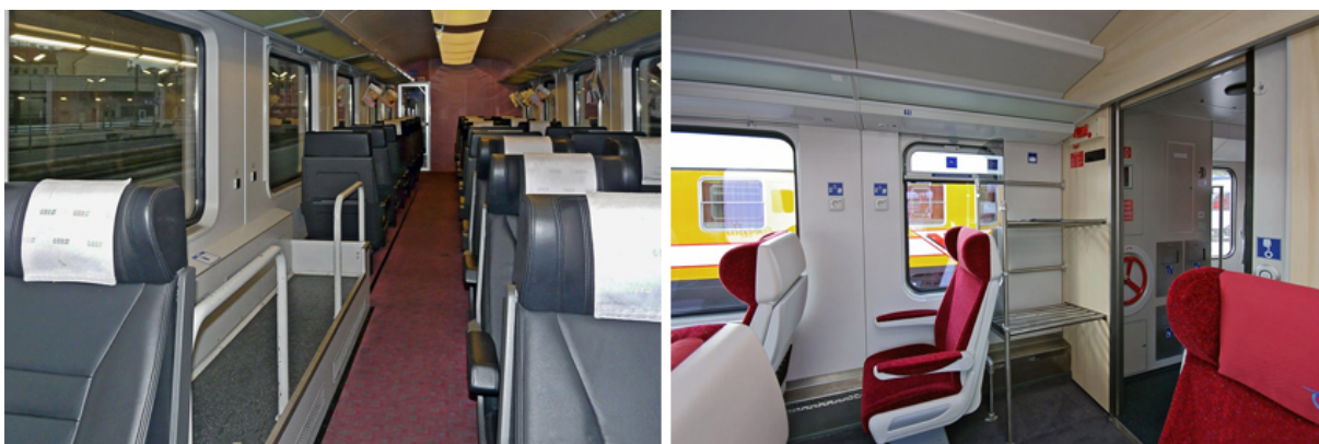
Obr. 34 Vyhrazené prostory pro objemnější zavazadla ve vozech ÖBB řady Ampz a ZSSK řady Ampeer
