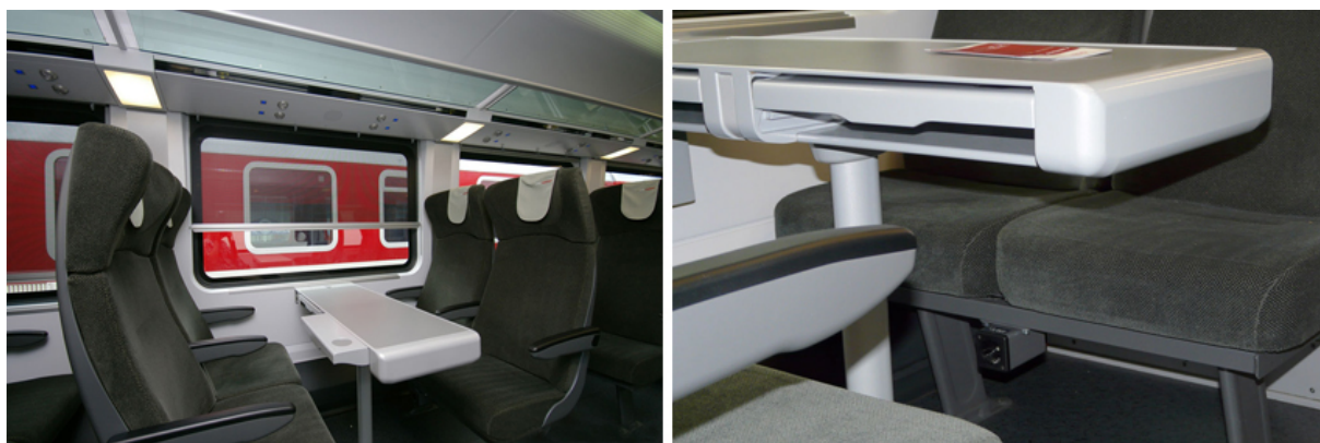
Obr. 31 Stolek s výsuvným panelem na nápoje a detail stolku se zásuvkou 230 V umístěnou ve spodní části sedadla ve voze ÖBB řady Bmpz
