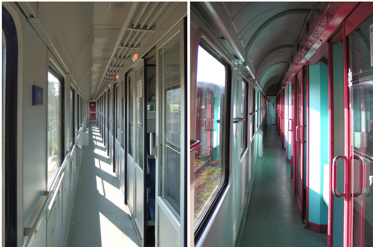
Obr. 26 Vozová chodbička vedená podél bočnice se sklápěcími sedadly a policí pro zavazadla nad vstupem do kupé u vozu ČD řady Bmz, chodbička u vozu ČD řady Beer
