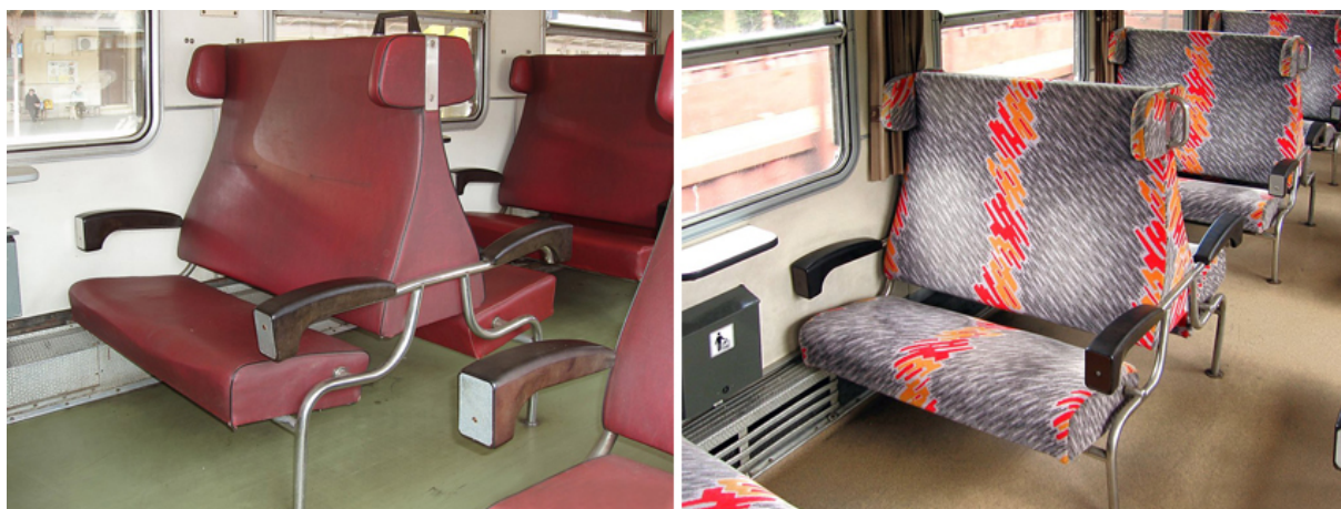
Obr. 44 Koženková sedadla ve voze ČD řady Bt a sedadla nově čalouněná plyšovým potahem ve voze ČD řady Btn
