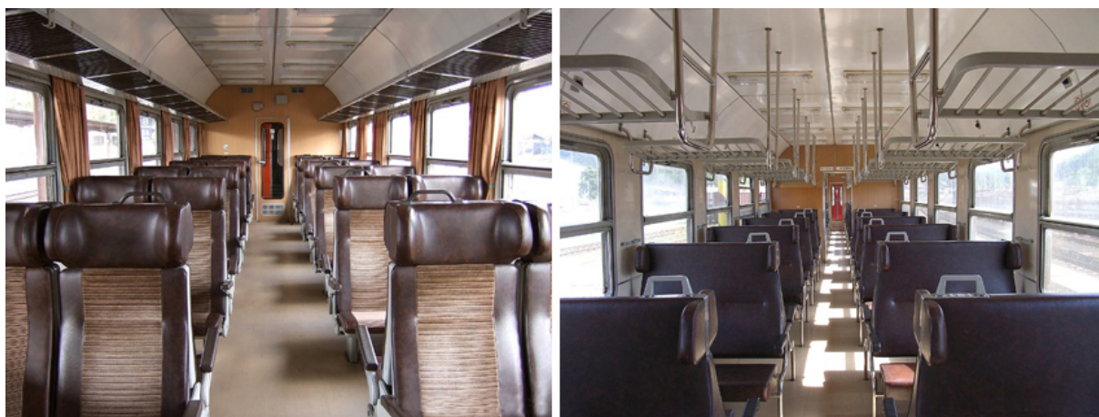
Obr. 27 Středové vozové chodbičky u vozů ČD řady Bp a Bdt se zavazadlovými policemi podél bočnice vozu a individuálně nad sedadly
