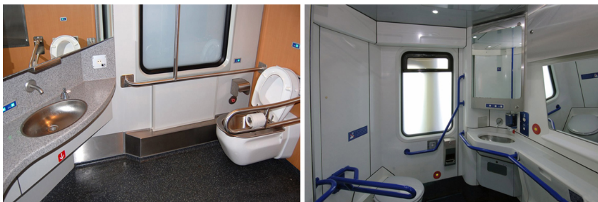
Obr. 37 Podtlakové toalety uzpůsobené pro přístup cestujících na vozíku ve vozech ÖBB řady Bbmzw a SBB řady Bpm
