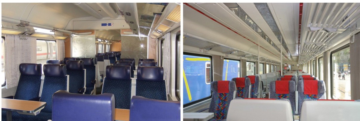
Obr. 28 Oddílová příčka u vozu ÖBB řady Bmpz, oddílová příčka u vozu ČD řady Ampz
