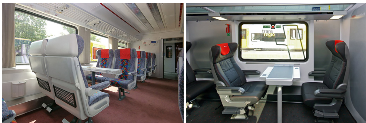
Obr. 46 Detail zádové opěrky se sklopným stolkem, sítkou na drobné předměty a opěrkou na nohy ve voze 1. třídy ČD řady Ampz a sedadla 1. třídy ve voze ÖBB řady Afmpz RailJet
