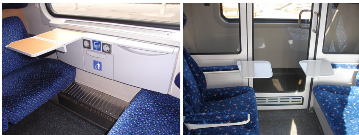
Obr. 33 Podokenní sklopné stolky se zásuvkami 230 V a košem na odpadky ve voze ÖBB řady Bmz a sklopné stolky ve voze ŽSSK řady Bdghmeer
