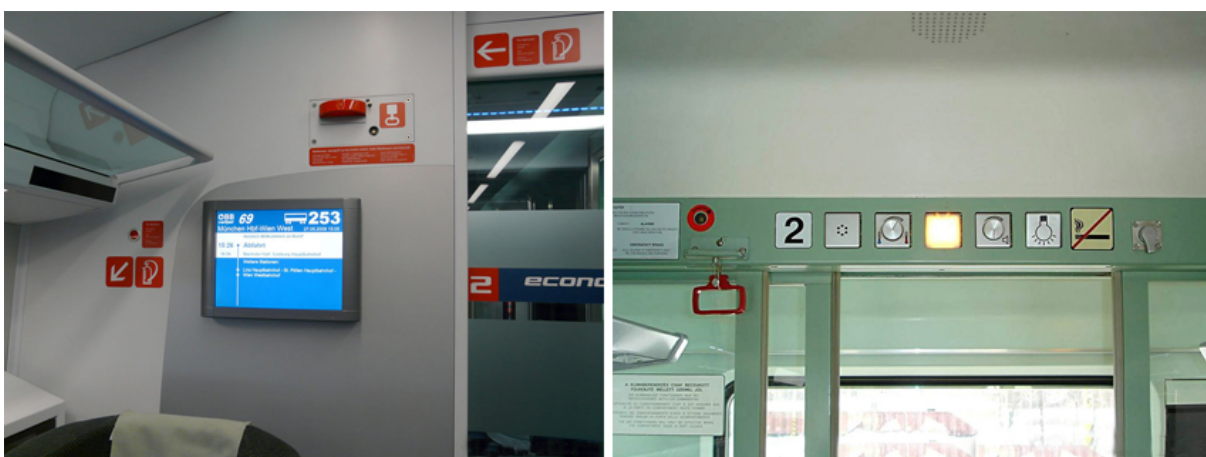
Obr. 36 Informační systém a táhlo záchranné brzdy ve voze ÖBB RailJet řady Bmpz a ovládací panel vytápění a osvětlení s táhlem záchranné brzdy v kupé vozu MÁV řady Bvmz
