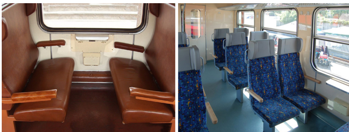
Obr. 43 Koženková sedadla ve voze ČD řady Bdmtee a sedadla potažená jemným plyšem instalovaná při rekonstrukci interiéru vozu ČD řady Bdmtee
