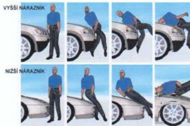
Obr. 13 - Vícepohová simulace střetu chodce s automobilem[10]
