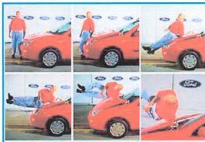
Obr. 18 - Systém aktivní kapoty (automobilka Ford) [10]
