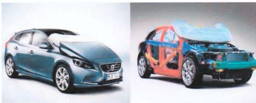
Obr. 17 - Systém pasivní bezpečnosti chodců (Volvo V 40) [10]
