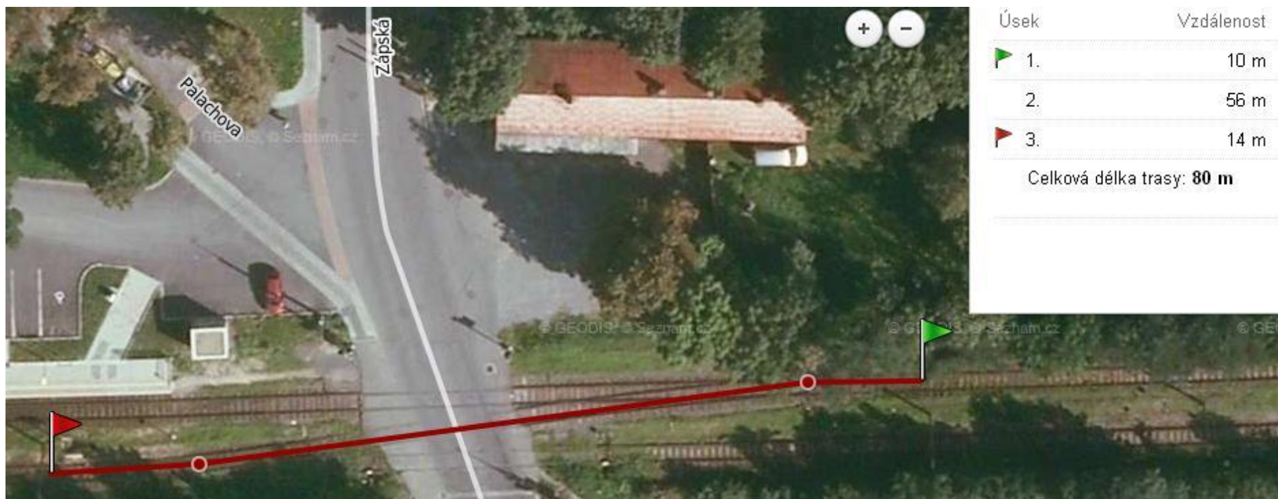
Obrázek příloha B: Mapa se vzdáleností, kterou musí ujet vlak při sunutí na vlečkovou kolej 1A
