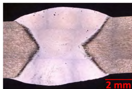
Obr. 4: Metalografické vzorky MIG svařování - X svar
