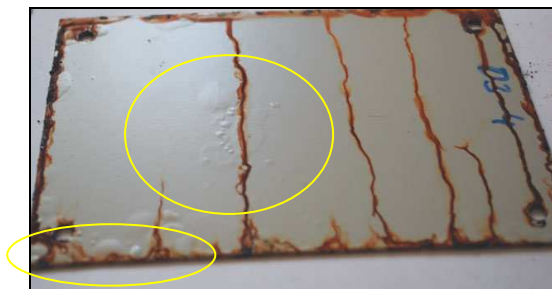
Obr. 2: Vzorek D3-4 po korozním zatížení – puchýře v ploše
