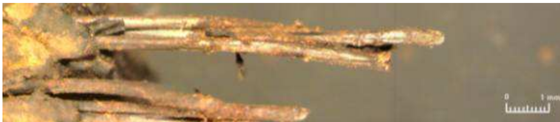
Obr. 1: Korózne pôsobenie na povrchu kordov oceľokordového nárazníka [2]
