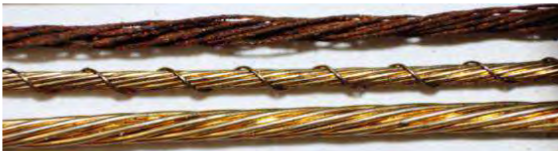
Obr. 3: Porovnanie ocelových kordov vo forme lanka, pred a korózneho skúšky
