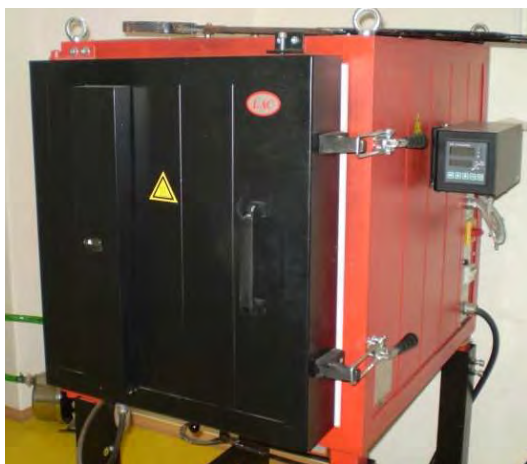
Obr. 2: Elektrická pec pro výrobu taveniny
