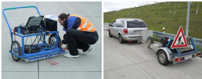
Obr. 4 Nasazení nedestruktivních metod při hodnocení polohy kluzných trnů a kotev na pokusných úsecích
