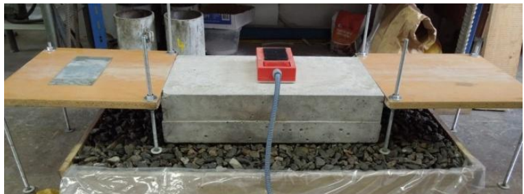
Obr. 29 Měření rychlosti šíření signálu na desce tloušťky 150 mm (měření B-R-4-CB 0,15)
