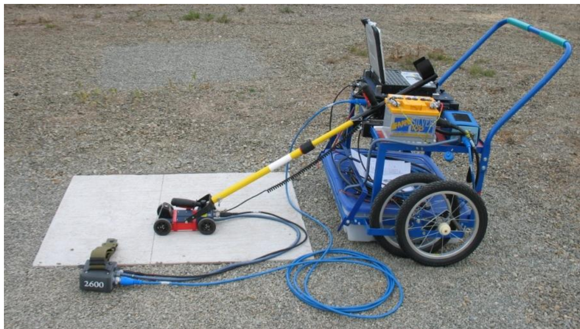
Obr. 38 Měření rychlosti šíření signálu a polohy kluzných trnů na laboratorní zkušební desce
