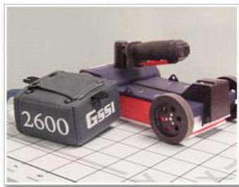
Obr. 29 Měření rychlosti šíření signálu na desce tloušťky 150 mm (měření B-R-4-CB 0,15)
