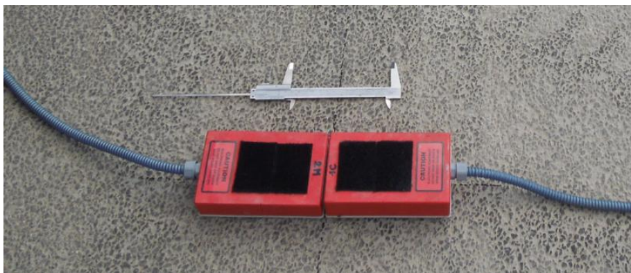
Obr. 65 Kalibrace rychlosti šíření elektromagnetického signálu metodou CMP
