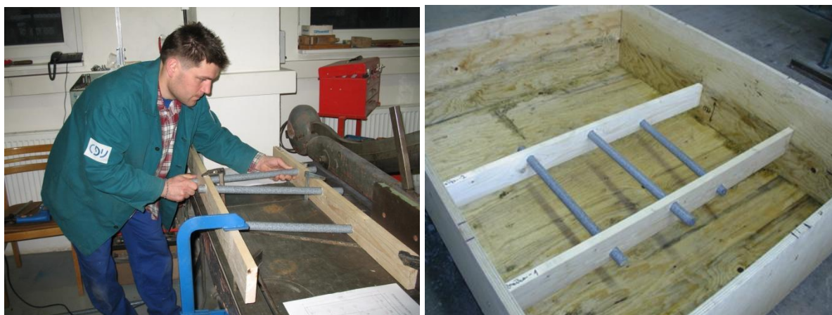
Obr. 25 Příprava uložení tří kluzných trnů před betonáží desky v akreditované laboratoři CDV v Tišnově
