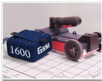
Obr. 28 Měření rychlosti šíření signálu na desce tloušťky 100 mm (měření A-H-0-CB 0,1)
