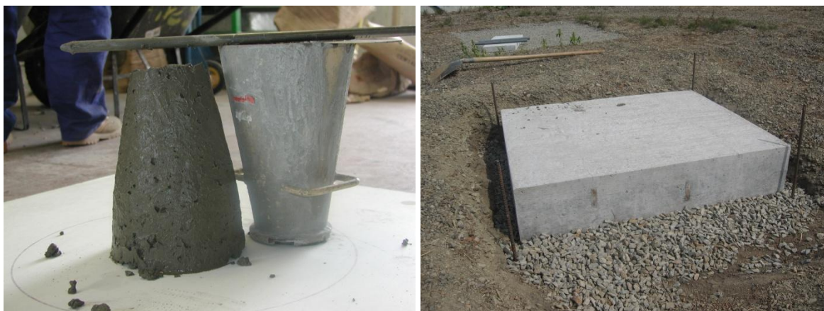
Obr. 26 Zkouška sednutí kuželem navržené směsi (vlevo) a pohled na betonovou desku tl. 240 mm (vpravo)
