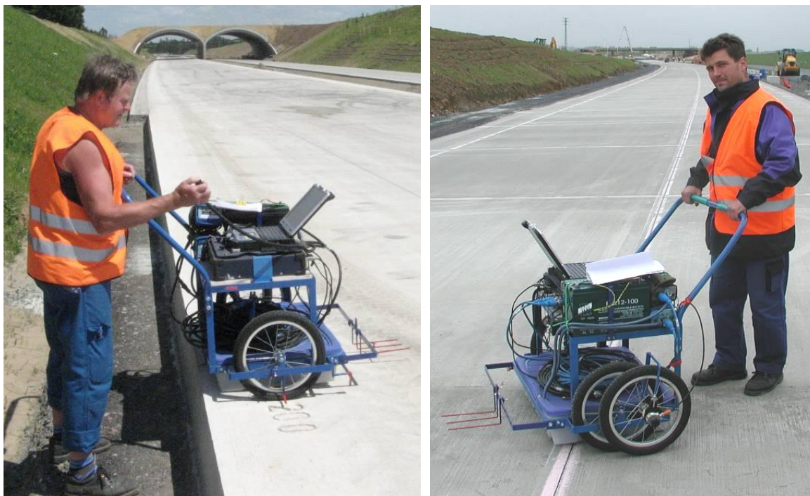
Obr. 60 Mobilní zařízení pro měření polohy kluzných trnů a kotev - foto z měření in situ
