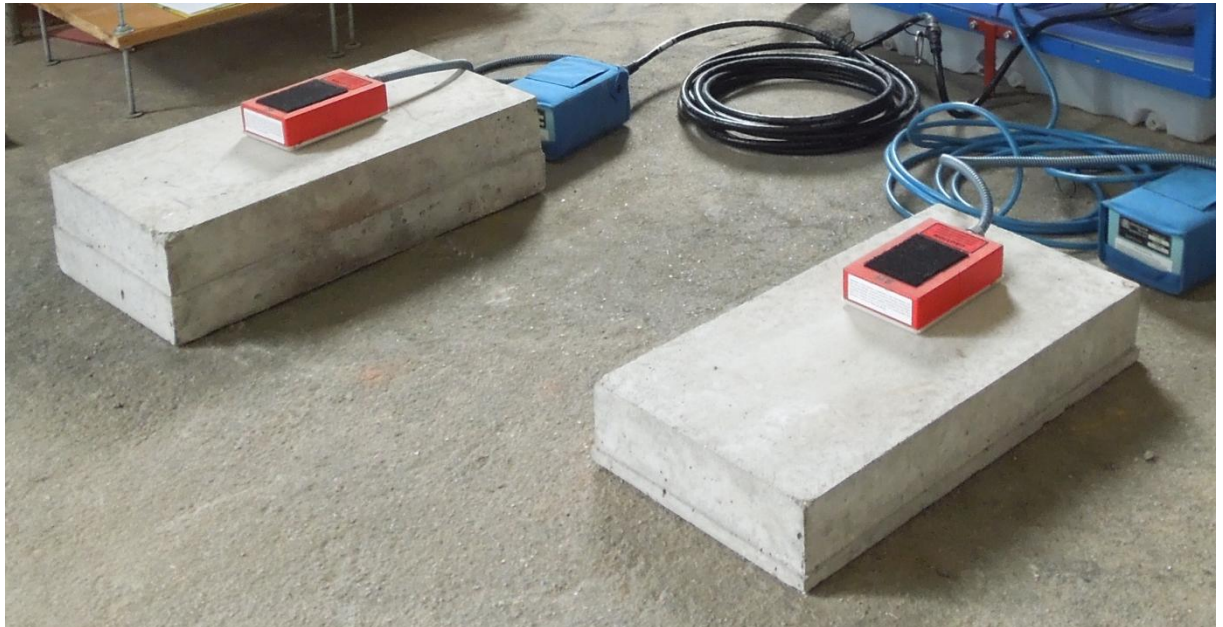
Obr. 23 Laboratorní cementobetonové desky tloušťek 100 a 150 mm
