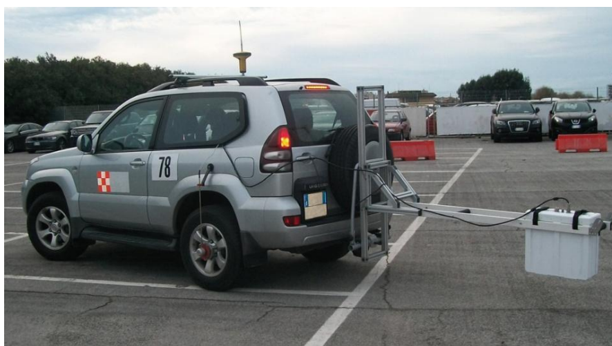
Obr. 5 Sestava RIS Hi-Pave - jedna trychtýřová anténa, odometr uchycen na kolo automobilu (zdroj Ingegneria Dei Sistemi)
