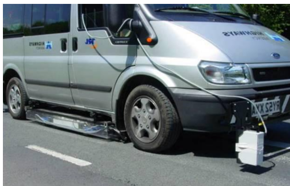
Obr. 6 Nainstalovaný set Groundvue 3 (pole antén typu dipól) a Groundvue 5 (trychtýřová anténa) firmy Utsi Electronics Ltd na měřicím vozidle Harris II (foto Transport Research Laboratory - UK)
