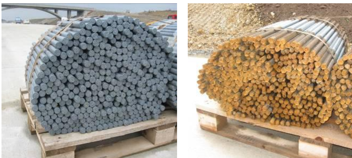
Obr. 12 Výztužné prvky před jejich použitím - kluzné trny (vlevo) a kotvy (vpravo).
