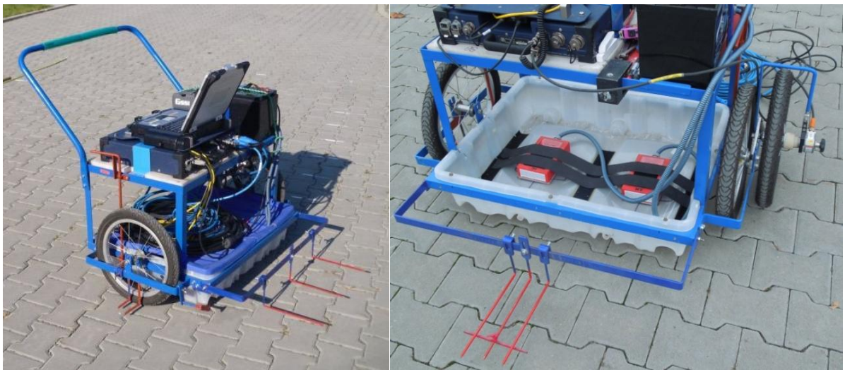
Obr. 59 Mobilní zařízení pro měření polohy kluzných trnů a kotev se dvěma anténami 1,6 GHz a polohovacím zařízením
