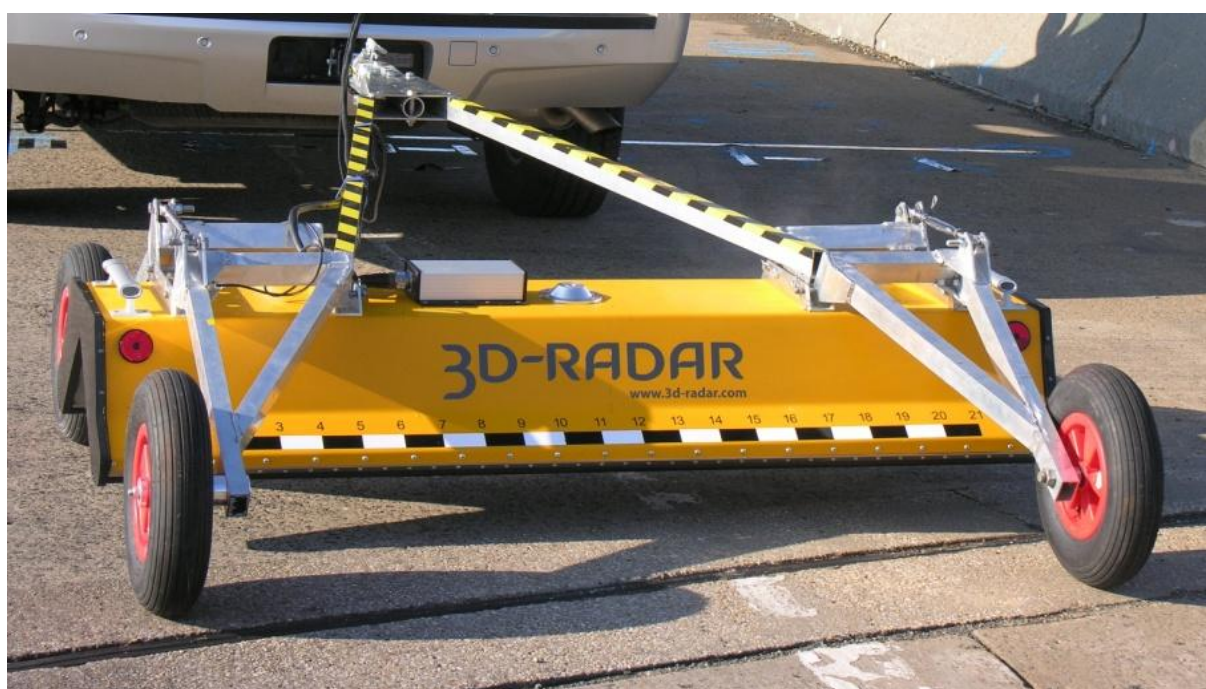
Obr. 7 Systém GeoScope™ Mk IV s polem antén šířky 1,8 m pro 3D mapování (zdroj 3D-Radar)
