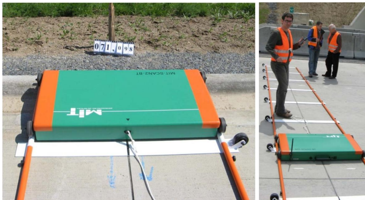
Obr. 76 Ukázka zařízení MIT-Scan při měření polohy kluzných trnů
