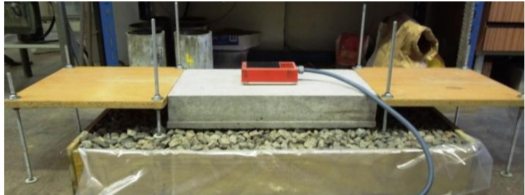
Obr. 28 Měření rychlosti šíření signálu na desce tloušťky 100 mm (měření A-H-0-CB 0,1)
