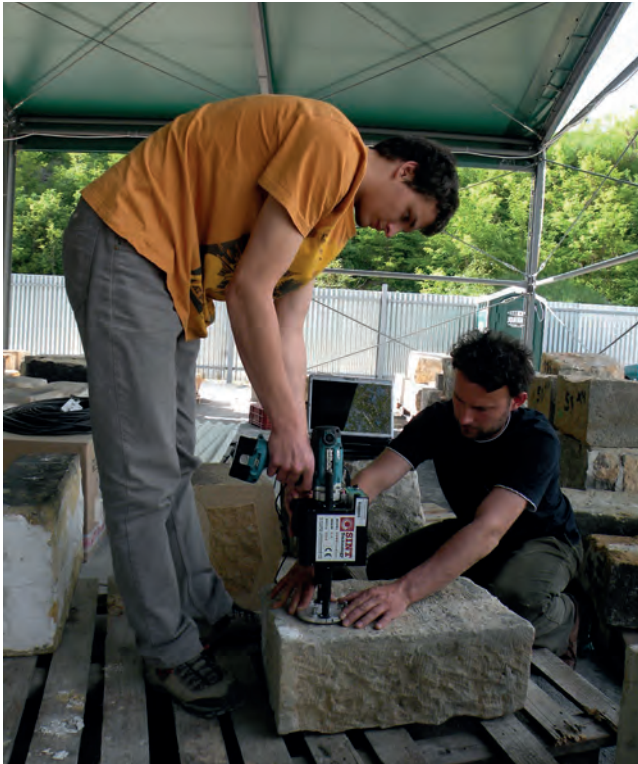
Měření kvality (pevnosti) povrchu kamenných kvádrů metodou odporového vrtání.
