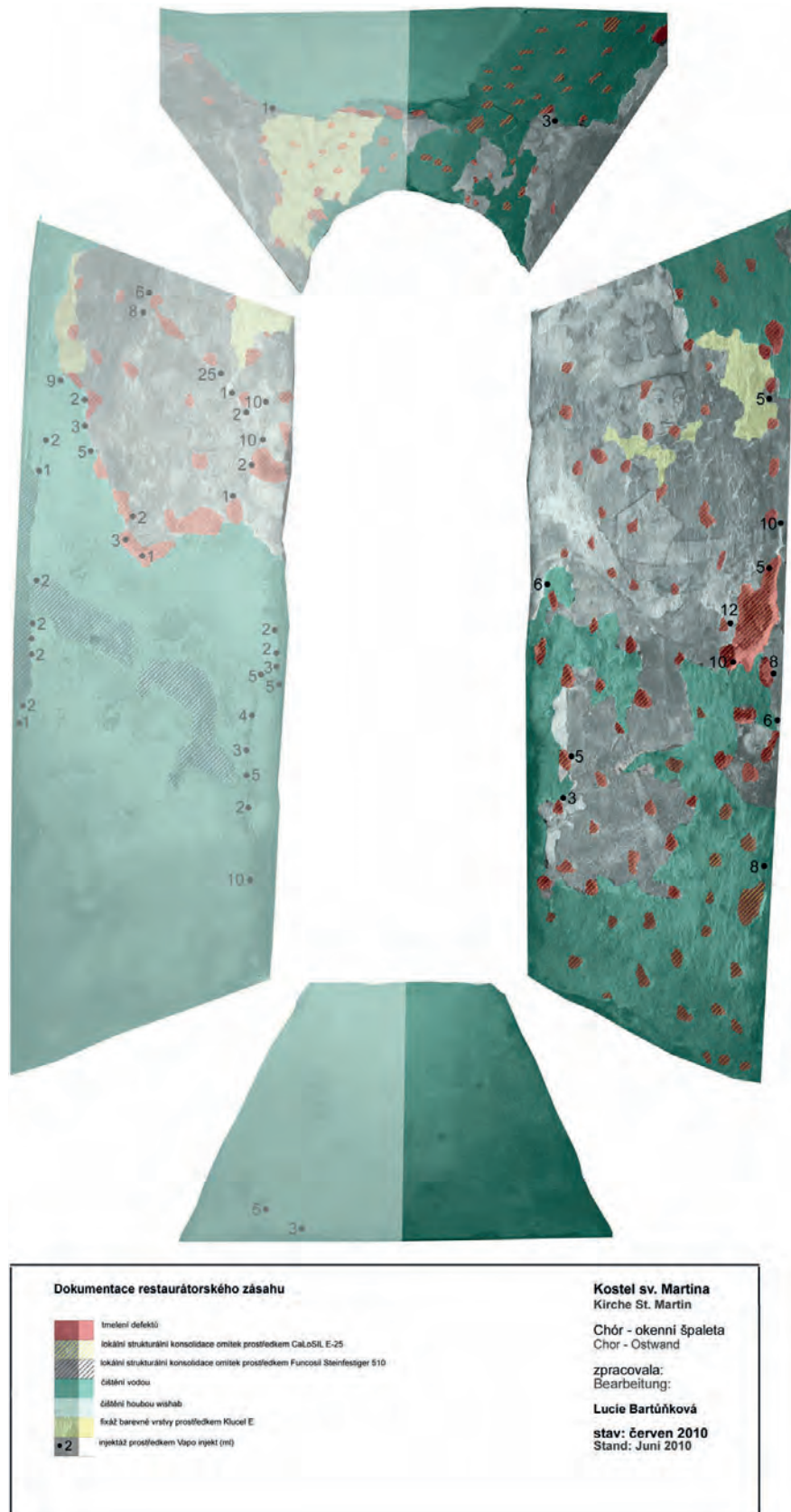
Grafická dokumentace restaurátorského zásahů v okenní špaletě.
