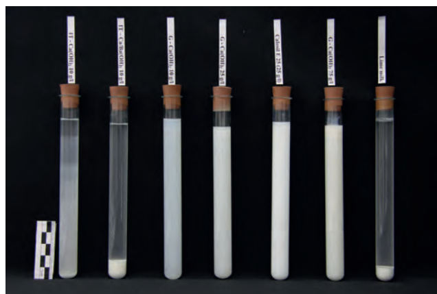
Laboratorní testování sedimentace nano-suspenzí hydroxidu vápenatého.
