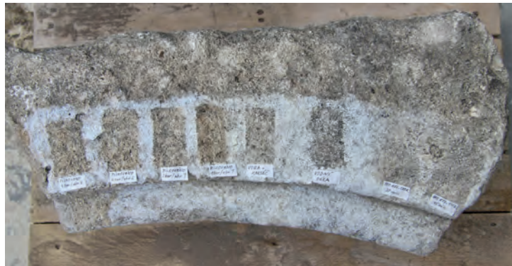
Zkoušky odstranění bílých zákalů provedených po aplikaci konsolidantu CaLoSiL® E25 na sochu anděla. Zleva: 4 zkoušky suchého abrazivního čištění; 2 zkoušky mokrého čištění; 2 zkoušky chemického čištění – buničinnové obklady s roztokem kyseliny citronové.
