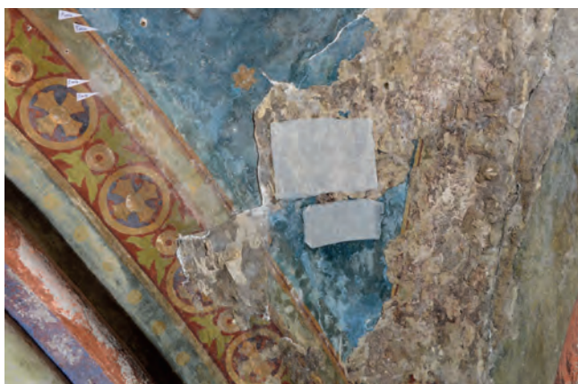
Chrám sv. Bartoloměje v Kolíně. Zkouška stabilizace solí pomocí kombinované nano-suspenze hydroxidu barnatého a hydroxidu vápenatého.
