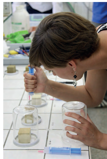
Testování penetrace laboratorních vzorků vápennými nano-suspenzemi.
