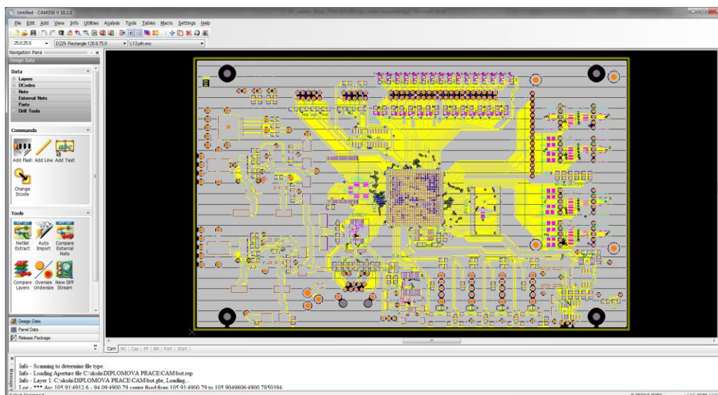
Obrázek 25 : Výsledek autoimportu do programu CAM350
