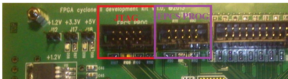
Obrázek 81 : Umístění programovacích konektorů na DPS
