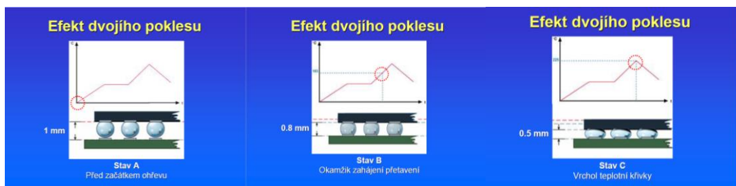
Obrázek 40 : Průběh efektu dvojího poklesu při pájení BGA [6]
