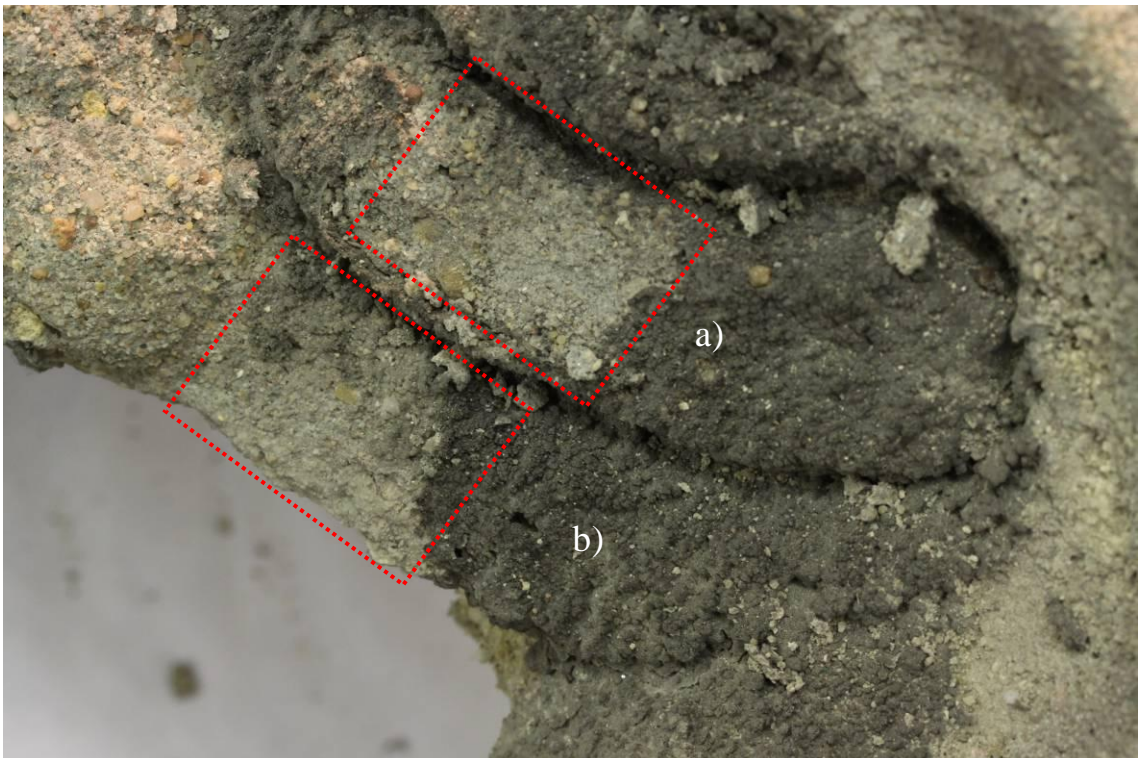
Obr. 40) Zkoušky čištění mikroabrazí, a) 1,5 baru b) 2,5 baru
