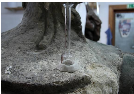
Obrázek č. IV, V, Vertikální a horizontální umístění Karstenových trubic při měření nasákavosti.
