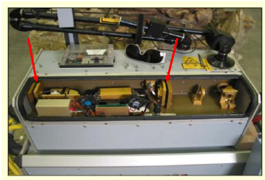
Obrázek č. XXVII, Pohled do nitra laserového přístroje, šipky označují zrcadla.
