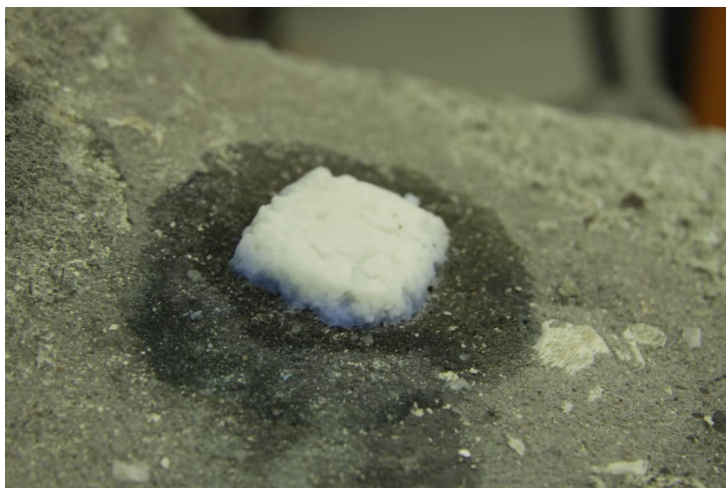
Obrázek č. XX , Zkouška čištění – zábal 10% uhličitanem amonným, modravé zabarvení indikuje účinek při odstraňování koroze mědi.
