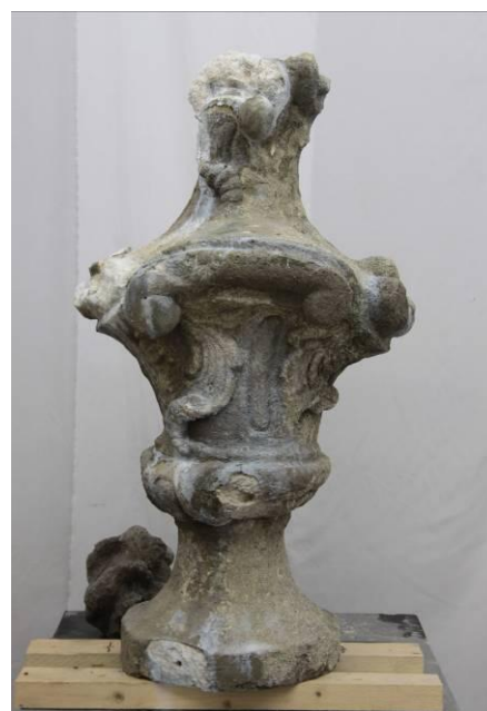
Obrázek č. XXIV, XXV, Bílý zákal na povrchu po aplikaci CaLoSilu.
