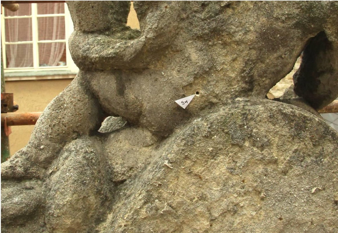
Obr. 10) Detail zadní části stav před restaurováním, místo odběru vzorku pro určení salinity
