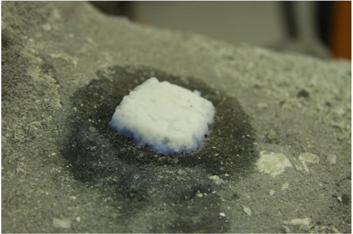
Obr. 41) Zkouška čištění – zábal uhličitanu vápenatého
