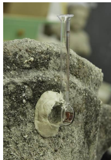
Obrázek č. IV, V, Vertikální a horizontální umístění Karstenových trubic při měření nasákavosti.
