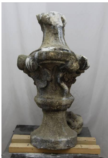
Obrázek č. XXIV, XXV, Bílý zákal na povrchu po aplikaci CaLoSilu.
