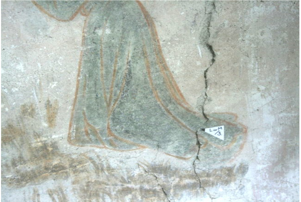
obr. 10, Loukov, kostel sv. Markéty, vítězný oblouk, Boj sv. Jiří s drakem , draperie princezny, odběr vzorků k mikrochemické analýze (LsvM/3.)
