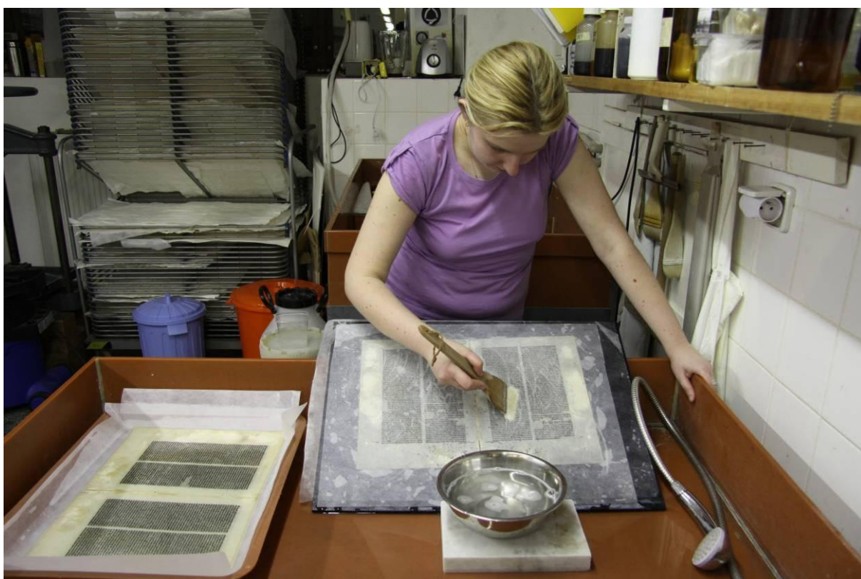
Obr. č. 38: Použití tenzidu na papírovou podložku.
