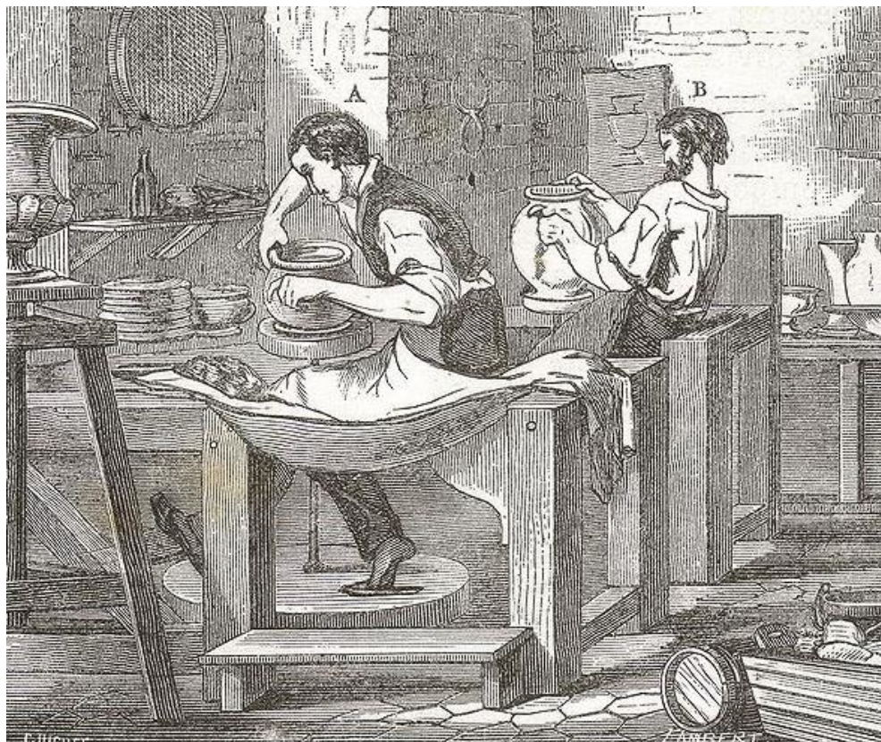
Výroba na hrnčířském kruhu. Vyobrazení z Agricolovy knihy De re metallica , 1556 3
