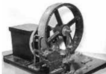
Obrázek 4 Jeden z prvních modelů polarografu (1924)
