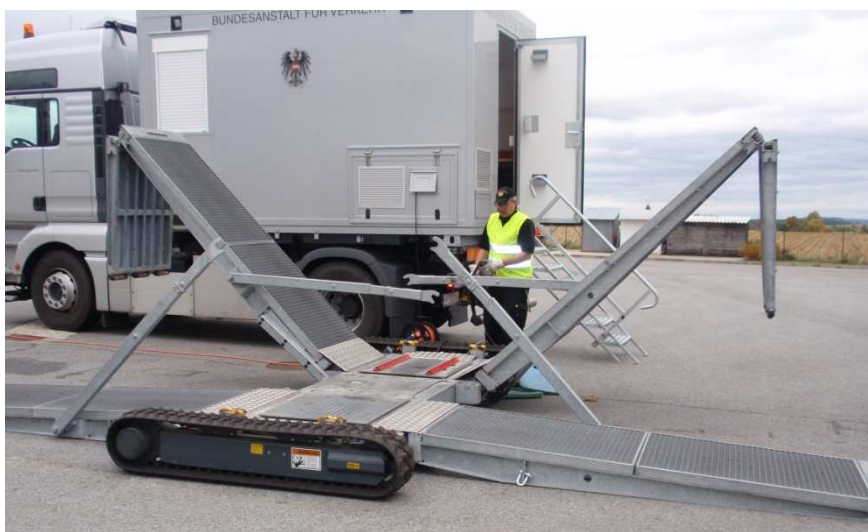
Obrázek 9 Rozkládací zařízení na kontrolu geometrie a vůlí náprav
