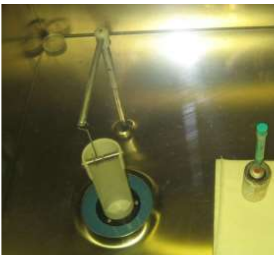
Obr. 20 Pohled do digestoře - vlevo studnový detektor, vpravo lahvička s radiofarmakem (autor, 2013)
