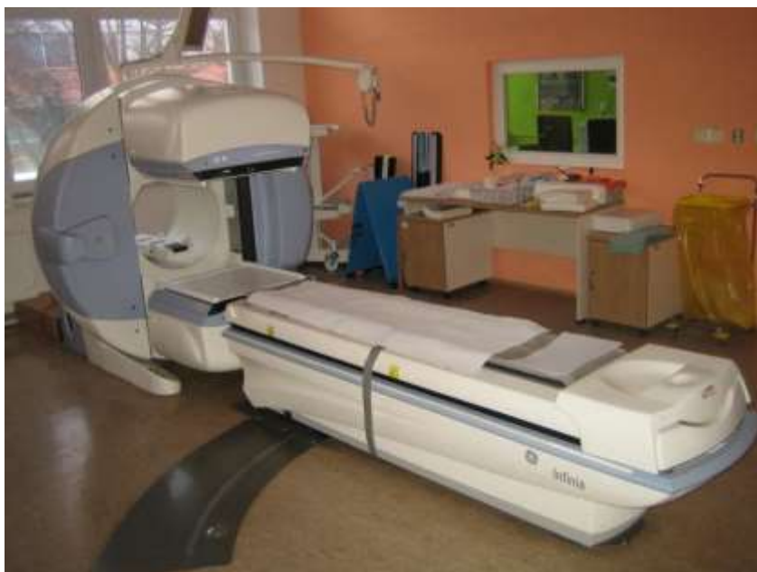
Obr. 27 Dvouhlavá gamakamera, vzadu okénko do ovladovny (autor, 2013)
