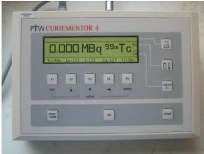
Obr. 21 Displej měřiče aktivity radiofarmaka (autor, 2013)
