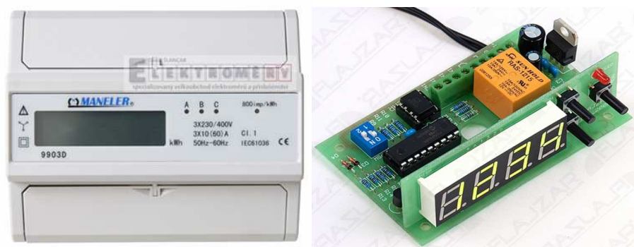
Obr. 20 Trojfázový elektroměr ( vpravo ) a čítač impulsů ( vlevo )
