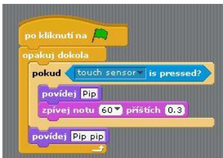
Obrázek 27: Dotykový senzor - při stisku tlačítka řídicí jednotka vydá tón
