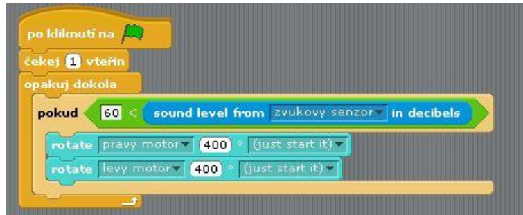
Obrázek 36: Zvukový senzor - zatleskej a pojed'
