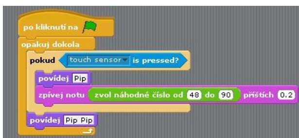
Obrázek 28: Dotykový senzor - při stisku tlačítka řídicí jednotka vydá různé tóny
