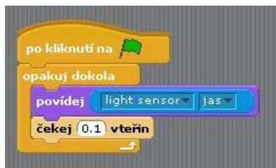
Obrázek 30: Světelný senzor - zobrazení intenzity světla bez auto kalibrace
