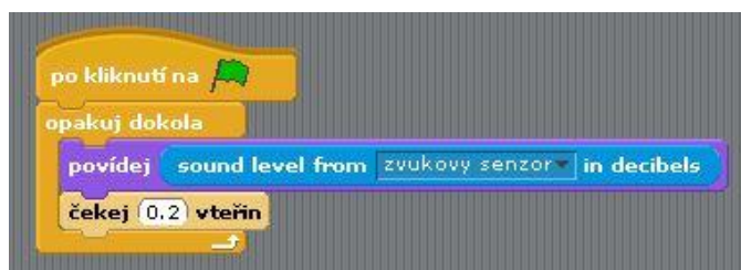
Obrázek 35: Zvukový senzor - zobrazení hlasitosti
