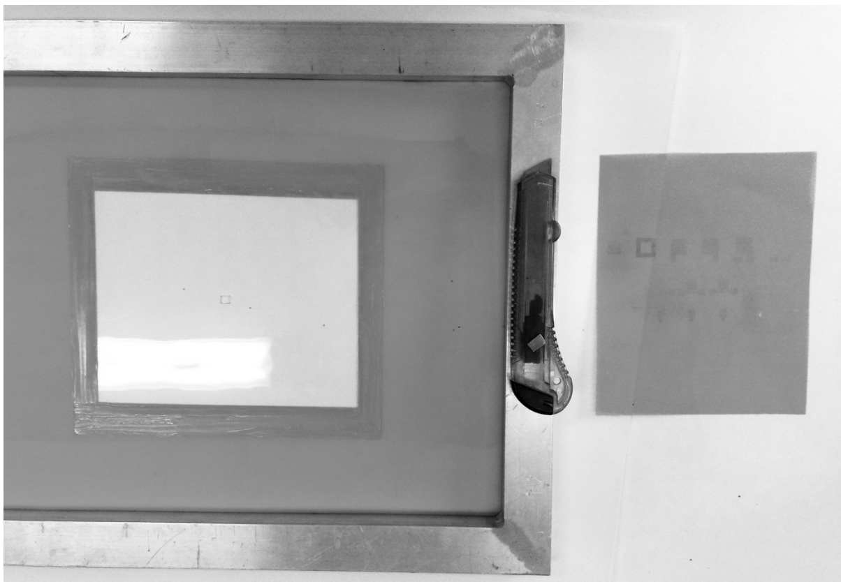
Obr. 2.3.2.3: Pripravená šablónová forma v ráme sita na šablónovú tlač.
