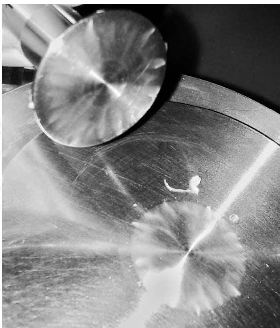
Obr. 3.5.1: formulácia F4 s PVC sa vytlačala z pod kužela v podobe zhlukov tuhého polyméru (vedľa kruhu premeranej formulácie vyššie na doske)
