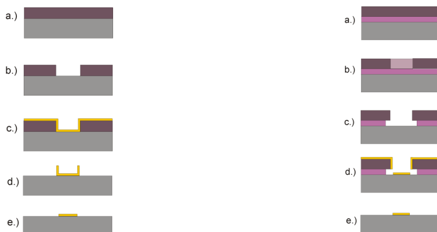
Obr. 1.4.1: Jednovrstvová varianta (vľavo) a dvojrvtvová (vpravo) „lift-off“ techniky [40].
