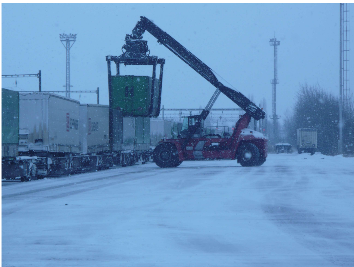
Obr. 3 Ložné manipulace s manipulačním strojem KALMAR DC450-60C5X
