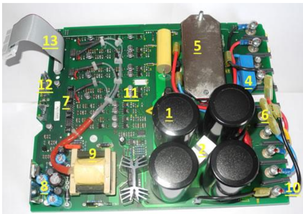
Obrázek 24 – Základní části frekvenčního měniče [3]
