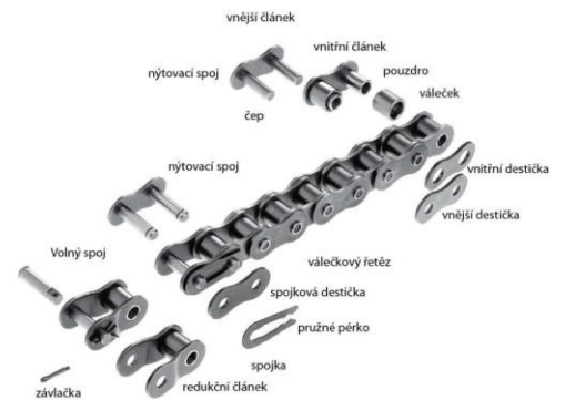
Obrázek č. 92: Schéma jednoduchého řetězového převodu [57] Obrázek č. 93: Součásti válečkového řetězu [58]
