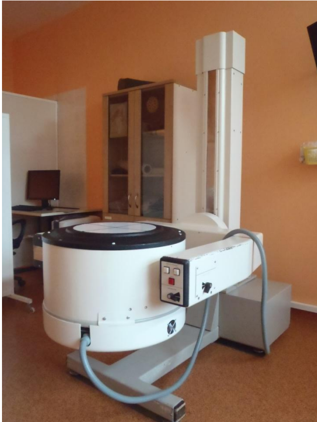
Obrázek 21 - Jednohlavá planární gamakamera 42
