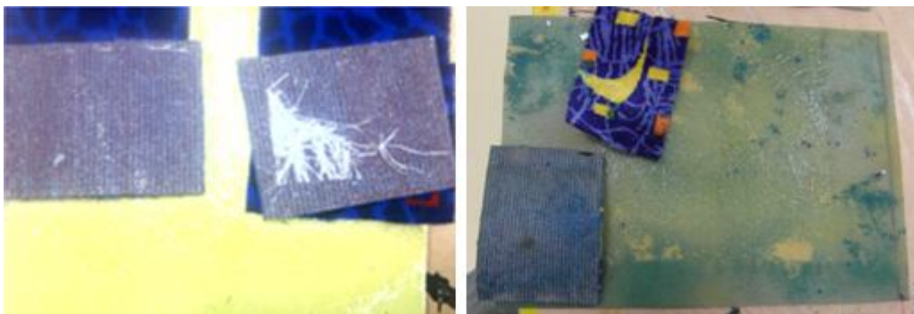
Obrázek 26 Čalounění po odlupové zkoušce ze skelného laminátu
