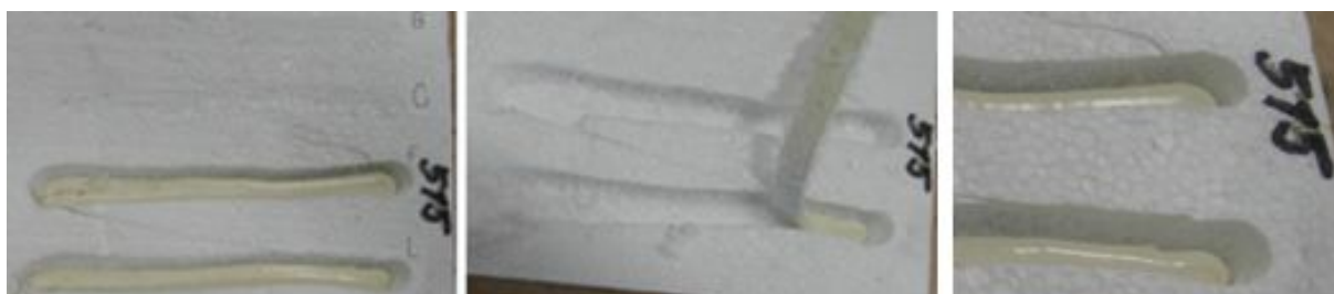
Obrázek 18 Adhezní zkoušky housenek z tmelu Sikaflex - 515 na polystyrenu
