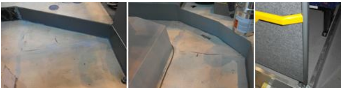
Obrázek 6 Podlaha bez lina, z části s linem a ostrý roh překrytý lištou
