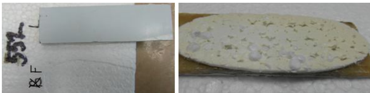
Obrázek 20 Odlupová zkouška mezi střešními materiály
