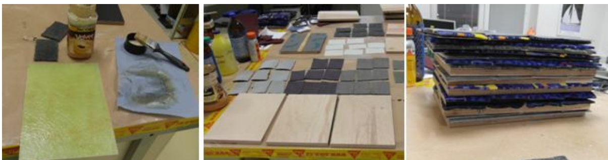
Obrázek 23 Nanášení lepidla UNILEP SPRAY H24 a tvorba vzorků
