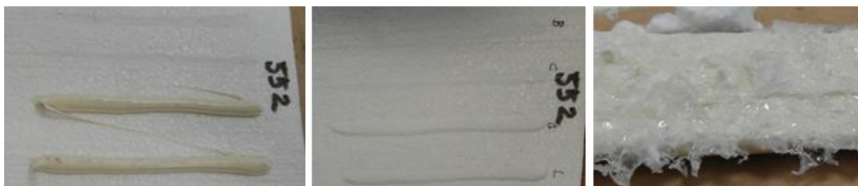
Obrázek 17 Adhezní zkoušky housenek z lepidla Sikaflex - 552 na polystyrenu
