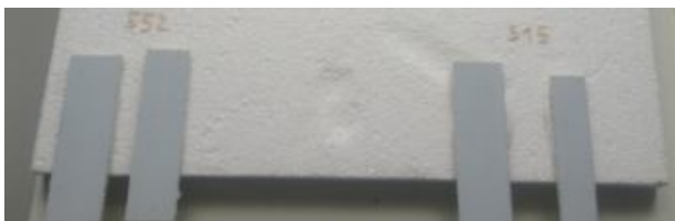
Obrázek 16 Spoje vytvořené mezi skelným laminátem a polystyrenem
