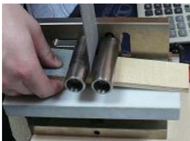
Obrázek 9 Válcové zařízení pro zkoušku odlupem, převzato z [1]
