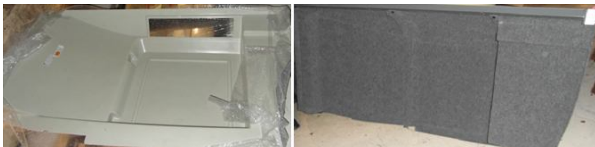
Obrázek 4 Výlisek z plechu bez koberce a s kobercem
