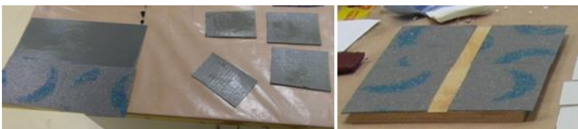
Obrázek 24 Nanášení lepidla SWIFT COL 2100 a tvorba vzorků
