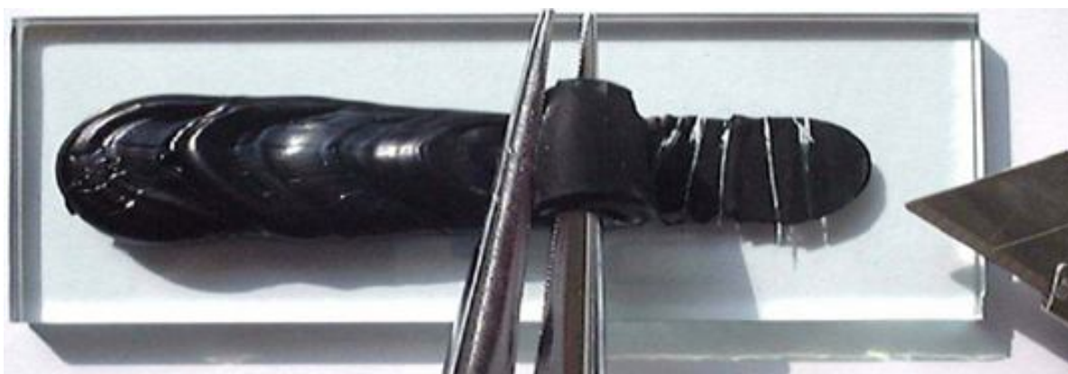
Obrázek 8 Zkouška adheze, převzato z [12]
