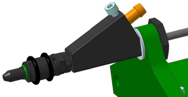
Obrázek 26 – Model prvků systému pro přívod šroubů
