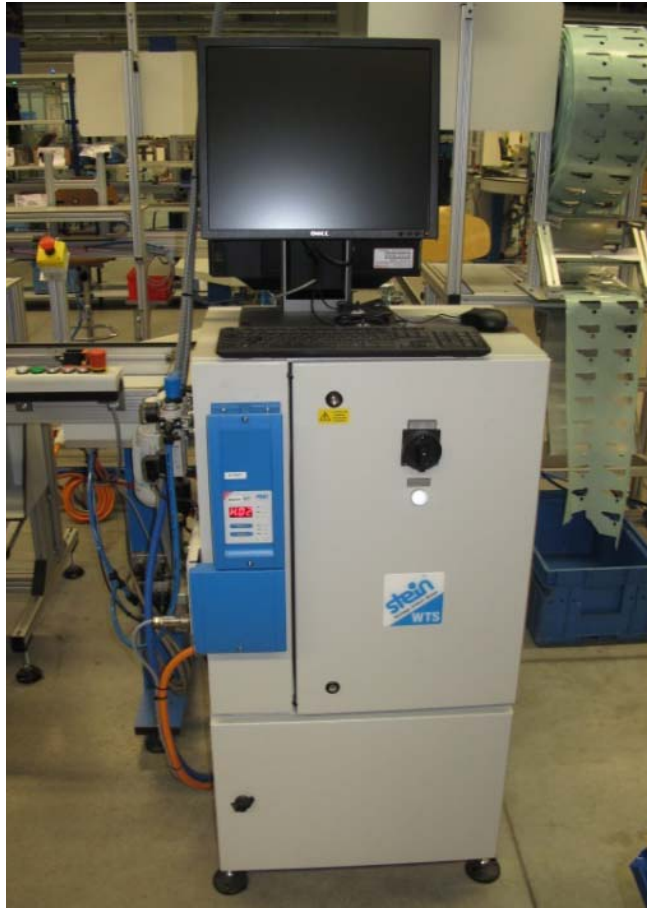
Obrázek 16 – Centrální systém řízení dopravníku
