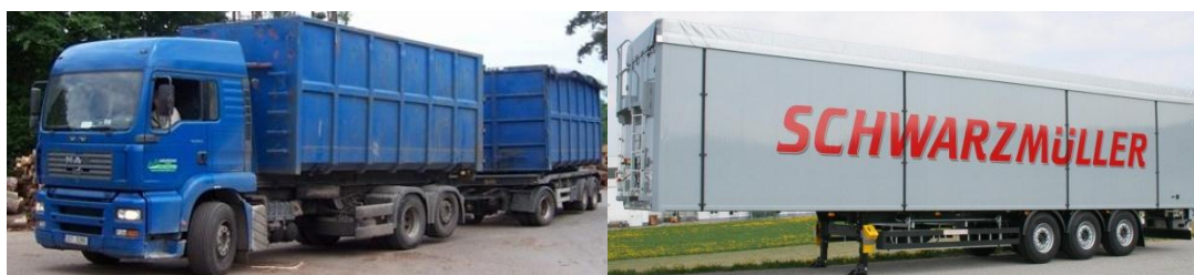
Obrázek 13: Přívěsová souprava s kontejnery ACTS; Třínápravový návěs s hliníkovým rámem a posuvnou podlahou
