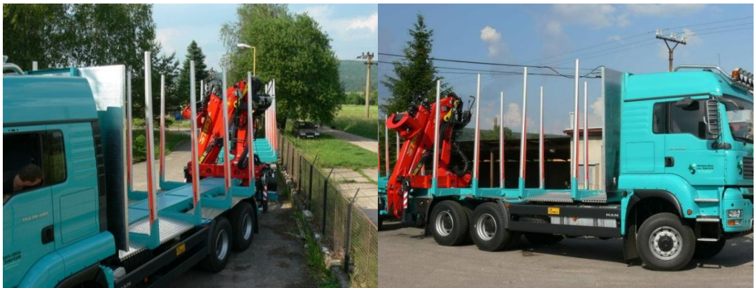
Obrázek 2: Vozidlo s oplenovou nástavbou a hydraulickou rukou na zádi
