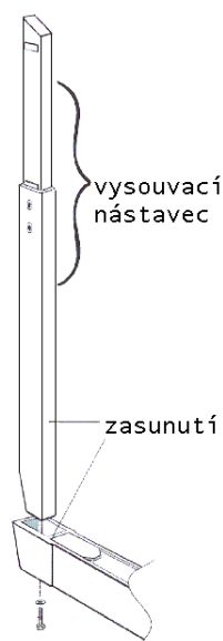
Obrázek 15: Samostatná stojina zasouvaná do domku na plošině
