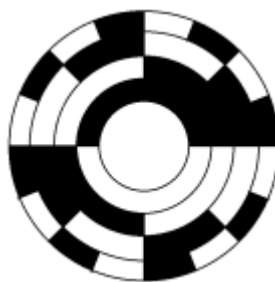
Obrázek 18 - Kotouč absolutního enkodéru
