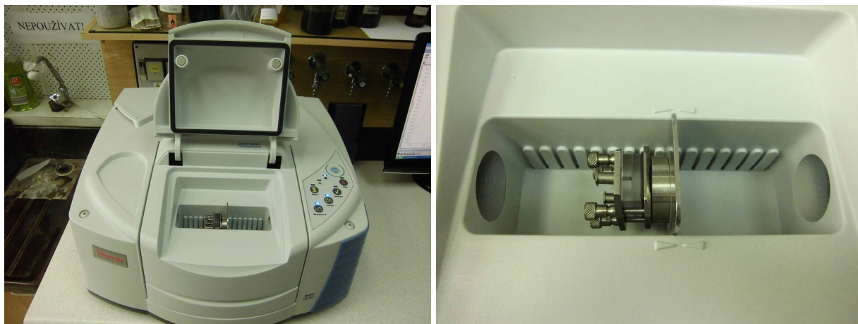
Obr. 10 – FTIR spektrometr Nicolet iS10 s nástavcem pro transmisní měření a kyveta
