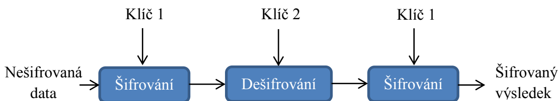
Obrázek 17 - Postup šifrování algoritmem 3DES
