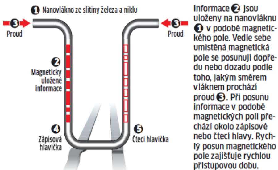
Obrázek 14 - Princip paměti Racetrack [23]
